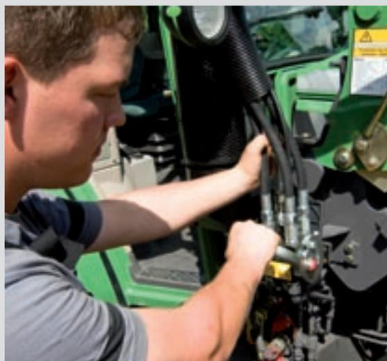
Un multicoupleur permet de connecter toutes les lignes hydrauliques et électriques à la fois, même sous pression du côté du chargeur frontal. Le chargeur frontal s'attelle et se déattelle extrêmement rapidement.
