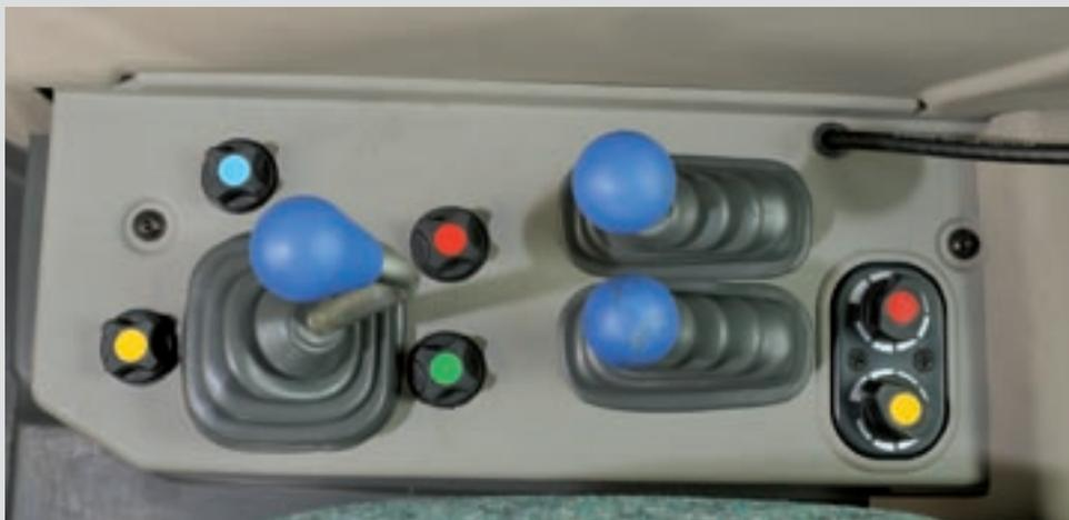
Les distributeurs 1 et 2 se contrôlent avec une grande précision grâce au levier en croix.
