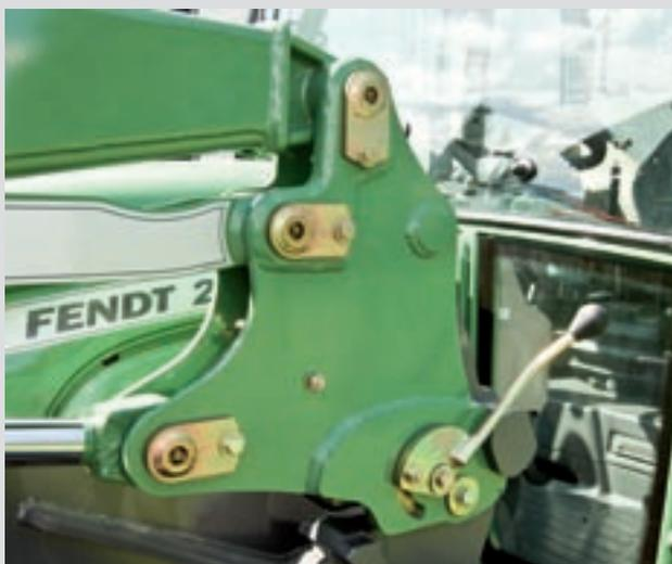
Le Fendt CARGO Lock vous permet d'atteler et de déatteler le chargeur frontal CARGO de votre 200 Vario encore plus rapidement et facilement. Grâce au verrouillage semi-automatique, vous n'avez plus à insérer de boulons d'arrêt, ce qui était souvent difficile. Le système offre également une sécurité d'utilisation maximum, grâce à l'attelage automatique du chargeur frontal.
