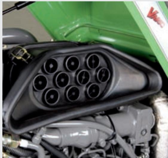
Le filtre à air avec pré-séparation cyclonique assure une efficacité maximum, malgré l'espace réduit dans les tracteurs compacts.
