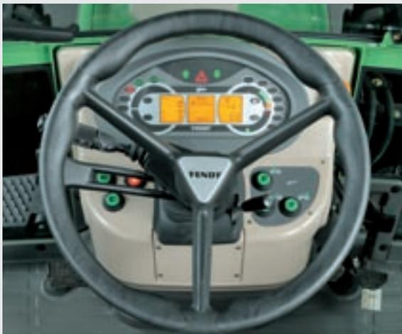
Le volant réglable en hauteur et en inclinaison permet à chaque conducteur de trouver sa position idéale.
