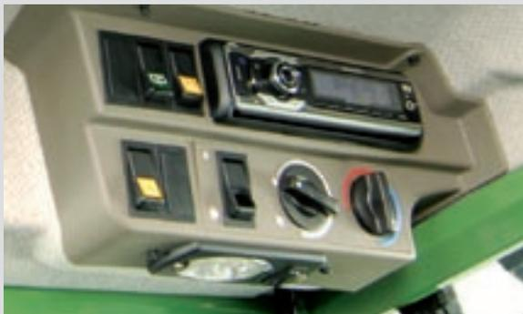
La cabine du nouveau 200 Vario est équipée d'un nouveau système de chauffage et d'une climatisation parfaitement intégrée (en option).
