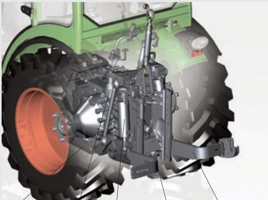
Relevage relié au capteur d'effort   Réglage hydraulique du dévers   Vérin de relevage   Réglage hydraulique du déport   Bras inférieur
